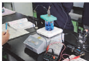
写真2 銅の電解精錬
